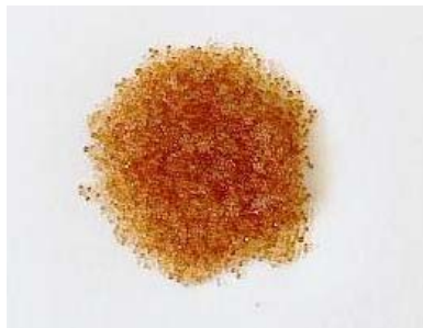
a. Resina de intercambio iónico (IRN 150, Copolímero Estireno-Divinylbenceno)
